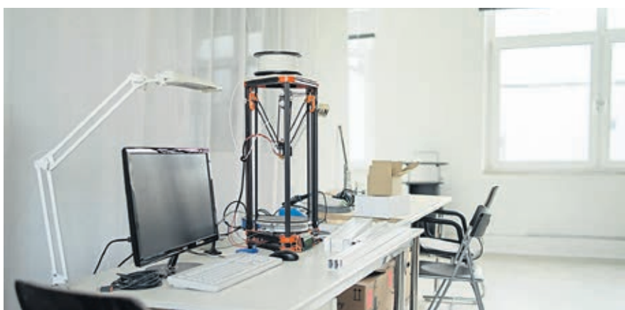
Der 3D-Drucker-Eigenbau mit Herdplatte ist sogar noch temperaturgenauer als 3D-Drucker mit Druckplatte.
